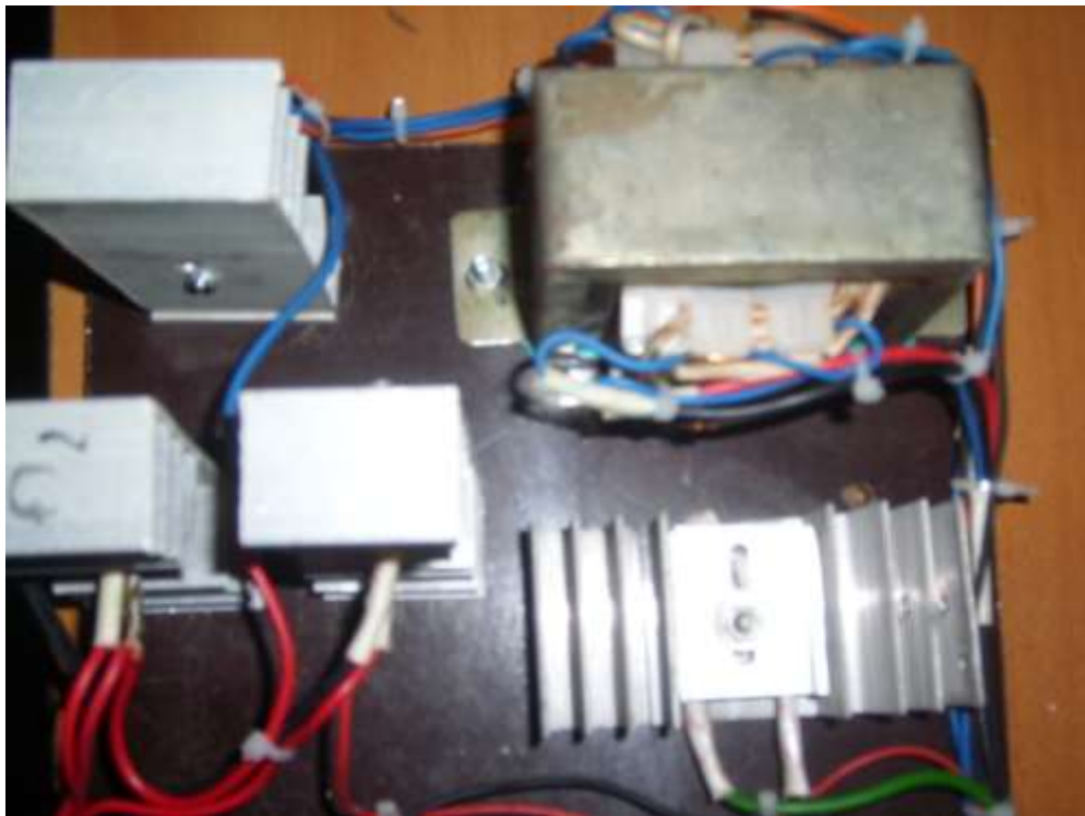
Bộ chỉnh lưu cầu và biến áp cấp nguồn hệ thống
