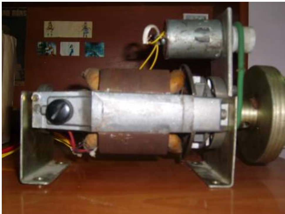
Động cơ điện một chiều kích từ độc lập
